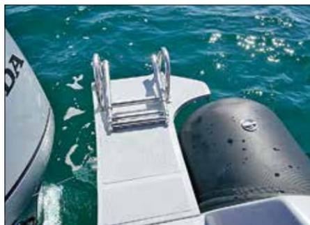
Les plages de bain remontent loin vers l'arrière, au-delà des flotteurs. Celle située à bâbord est équipée d'une échelle.
