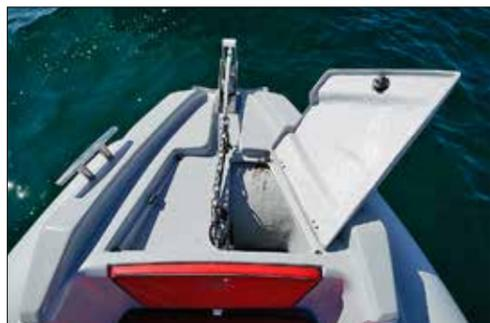
Une pièce en polyester coiffe la partie supérieure des flotteurs et intègre les équipements dédiés au mouillage : baille, guindeau, etc.
