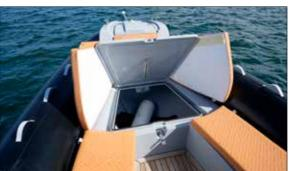
Astucieux, le système de fixation des coussins permet d'ouvrir le coffre sans avoir à retirer la sellerie. Bien vu !
